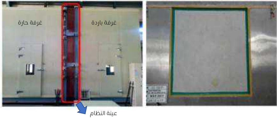
رسم توضيحي 19: اختبار النظام لتحديد معامل الانتقال الحراري
